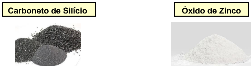
Figura 2 – Elementos de Fabricação dos Varistores
